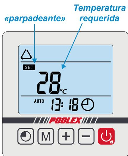
Quando el símbolo **SET** deje de parpadear, la temperatura requerida se confirma y es sustituida por la temperatura actual del agua (25° en este ejemplo).
