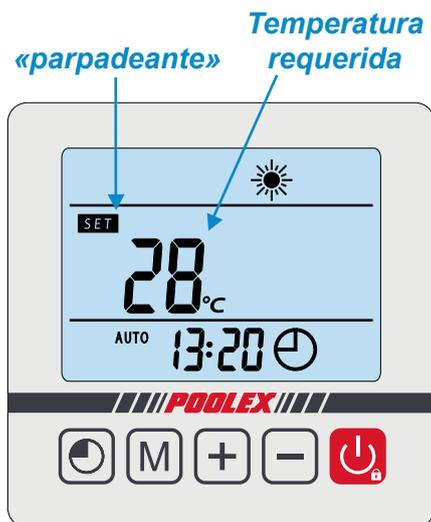
Cuando el símbolo **SET** deje de parpadear, la temperatura requerida se confirma y es sustituida por la temperatura actual del agua (25° en este ejemplo).
