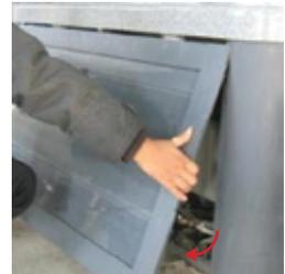
Pour refermer la jupe, placer le haut de la jupe dans son logement, puis soulever le jusqu'à ce que le bas soit aligné à la structure. Faites le maintenant descendre légèrement jusqu'à son verrouillage.
