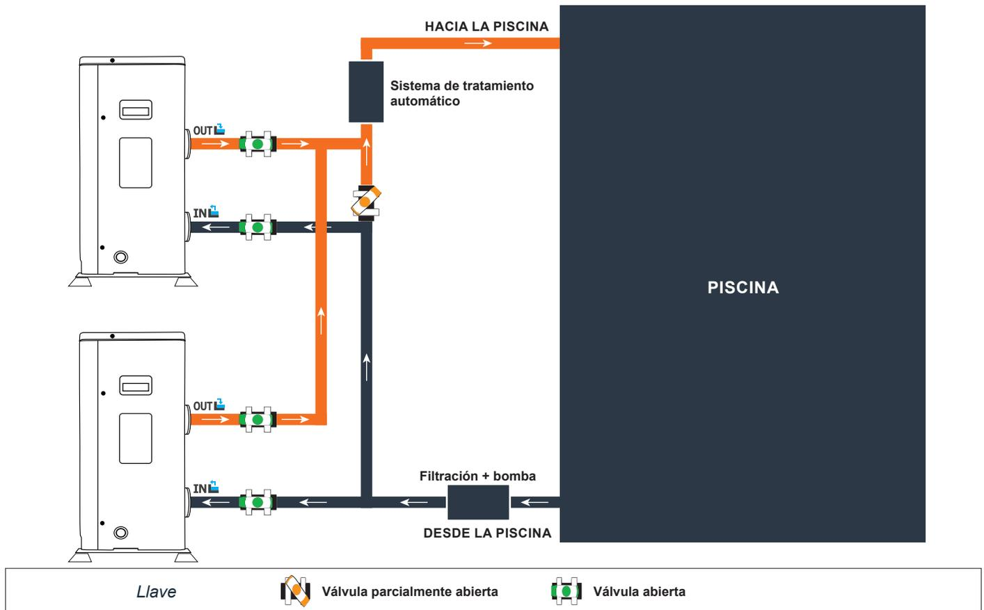
El filtro ubicado antes de la bomba de calor debe limpiarse regularmente para que el agua del sistema esté limpia y evitar de este modo problemas de funcionamiento derivados de la suciedad o el atascamiento del filtro.
