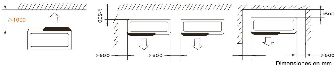
No coloque ningún objeto a menos de un metro de distancia por delante de la bomba de calor.
