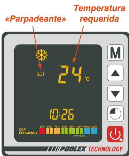
Cuando el símbolo **SET** deje de parpadear, la temperatura requerida se validará y será sustituida por la temperatura actual del agua (27° siguiendo con el ejemplo).
