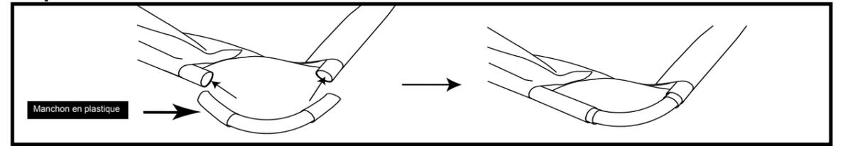
Utilisez l'extrémité de connexion du tube en L pour connecter les tubes horizontaux adjacents avec le manchon en plastique transparent.
